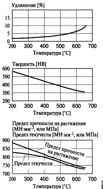
Рис. 3.2. Влияние эффекта заковки с последующим отпуском на свойства стали
