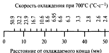
Рис. 2.4. Скорости охлаждения на различных расстояниях от закаливаемого конца образца для испытания Джоменн
